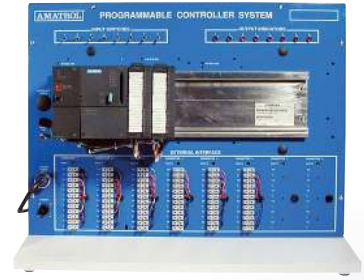
Siemens S7 PLC
